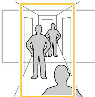
1. В зависимости от устройства поверните камеру или 3-осный объектив камеры на 90° или 270°.
